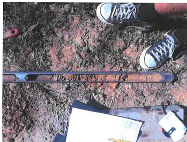
Figura 11: Stratificația întâlnită în forajul F2
