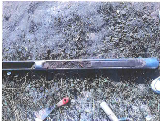
Figura 10: Stratificația întâlnită în forajul F1
