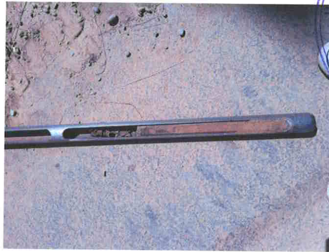
Figura 12: Stratificația întâlnită în forajul F3
