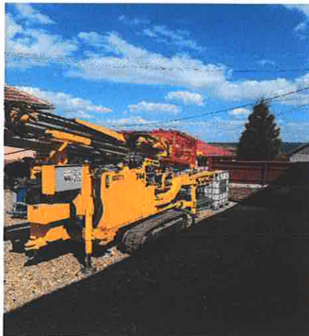
Figura 9.a: Utilaj de forat Beretta T44
